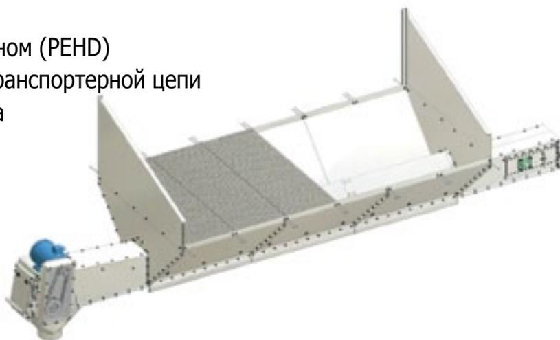
Приемные бункера полностью изготовлены из оцинкованной стали высокого качества. Все элементы соединены при помощи болтов, что облегчает сборку и техосмотры. Приемные бункера запроектированы как модульная конструкция ( размеры модуля: ширина 2 м, длина 1,4 м ).
